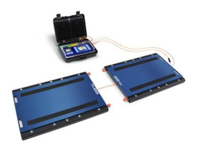
Spezieller Bausatz zur statischen manuellen Achsenverwiegung. Dieser besteht aus zwei tragbaren Plattformen der Serie WWS und dem Touchscreen-Wägeindikator 3590ETKR, mit integriertem Drucker. Die Benutzeroberfläche ist intuitiv, klar und einfach und zeigt in Echtzeit das Gewicht der Achse, das Gesamtgewicht, die Tara sowie den Identifikationscode von Fahrzeug an. Im Ticket werden alle Wägedaten erfasst, um die Registrierung und Rückverfolgbarkeit zu erleichtern.
